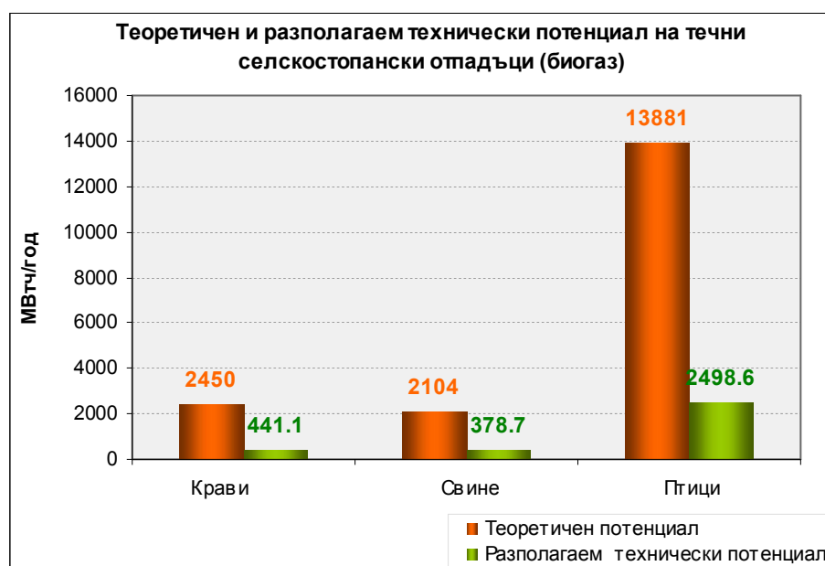
Фигура 3. Теоретичен и технически потенциал на течни селскостопански отпадъци (биогаз).
